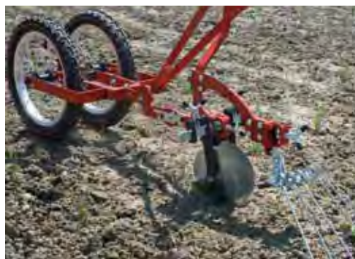
Radhacken sind eigentlich Geräteträger. Hier ist eine Zweiradhacke mit Schermesser und Striegel zu sehen.
