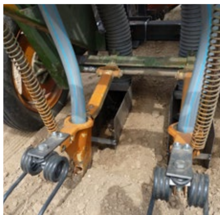
Prototyp einer Maschinenkombination aus Kompostbunker und Drillmaschine zur Kompostausbringung der Saatreihe und eine Detailabbildung der Saatschare des Prototyps (Bild: D. Werren, Universität Kassel)
